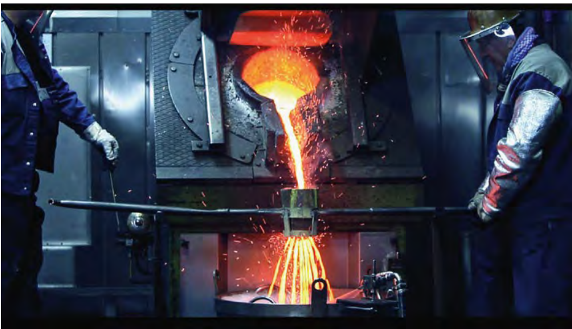
Gewinnung von 17 Feinmetallen, gezeigt hier der Goldabstich
