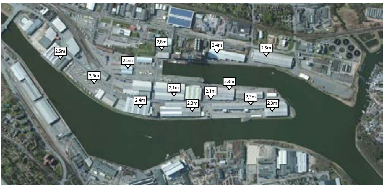
1.61 > Höhenangaben des Terminals Vorwerker Hafen
