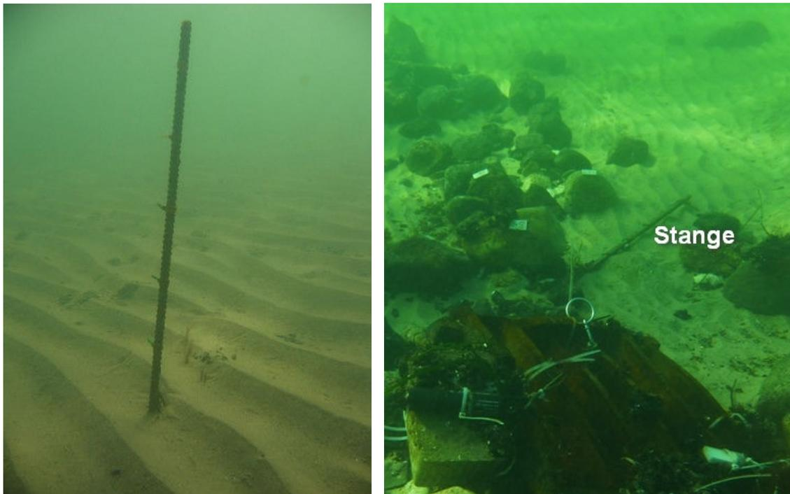
Abb. 28: Standort Brodten1, Lübecker Bucht: Sediment-Messstange 20 cm tief im Sand im Februar 2013 (linkes Bild), drei Wochen später freigelegte ehemalige *Fucus*-Steine, Stange unterspült auf dem Boden liegend (rechtes Bild)
