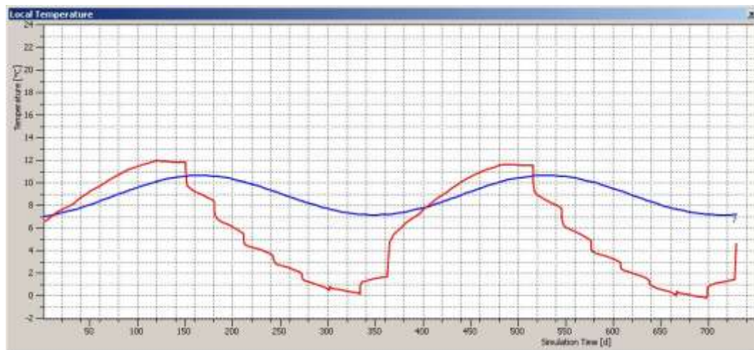
Abb.19: Y-Achse = prognostizierte mittlere Fluidtemperaturen (rot) und ungestörte Untergrundtemperatur (blau); X-Achse = Simulationszeit in Tagen, ausschließlicher Heizbetrieb
